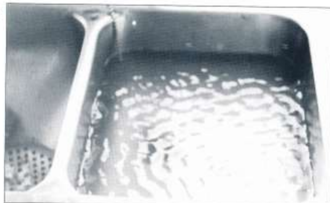
Vid ett visst varvtal på maskinen uppstår resonans mellan vibrationerna i skrovet och vattnet i diskben med tjusiga stödnande vågor som följer. Foto Anders Holmström
